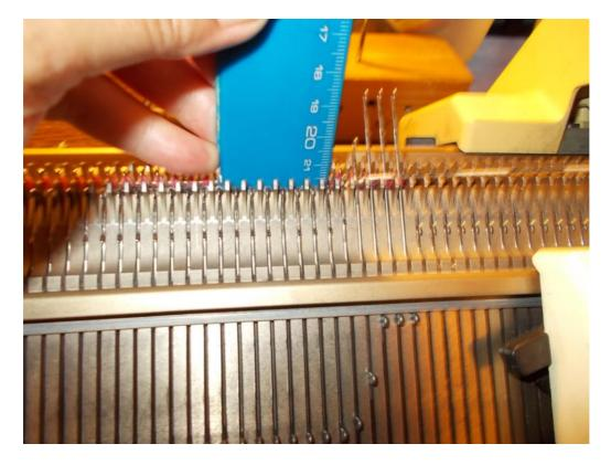
16 R. jeweils auf der Schlittenseite die äusserste Nadel wieder in Betrieb nehmen, Faden dabei hinter die Nadel legen und beim Abstricken evtl. mit dem Hakenwerkzeug nachhelfen. Randkrallen in jeder Reihe nachhängen!
